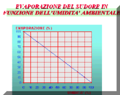
FIG. 45) PERCENTUALE DI EVAPORAZIONE DEL SUDORE IN FUNZIONE DELL'UMIDITÀ AMBIENTALE. SI NOTI COME LA CORRELAZIONE TRA I DUE PARAMETRI SI PRESENTI LINEARE, INVERSAMENTE PROPORZIONALE E CON INDICE DI CORRELAZIONE UGUALE A 1. DALL'ANALISI DI QUESTA RELAZIONE APPARE EVIDENTE COME, CON L'AUMENTARE DELL'UMIDITÀ, DEVE ESSERE PRODOTTA, PER PERDERE 1 KCAL, UNA QUANTITÀ DI SUDORE PROGRESSIVAMENTE SUPERIORE A 1.724 GRAMMI; TALE QUANTITÀ, OVVIAMENTE, È FUNZIONE DIRETTA DELLA FRAZIONE DI EVAPORAZIONE. PER TUTTI I VALORI DI UMIDITÀ AMBIENTALE È PERTANTO POSSIBILE CALCOLARE LA PRODUZIONE DI SUDORE, QUINDI LA PERDITA DI LIQUIDI CORPOREI, CHE SI RENDE NECESSARIA PER GARANTIRE, CON L'EVAPORAZIONE, LA TERMODISPERSIONE.
